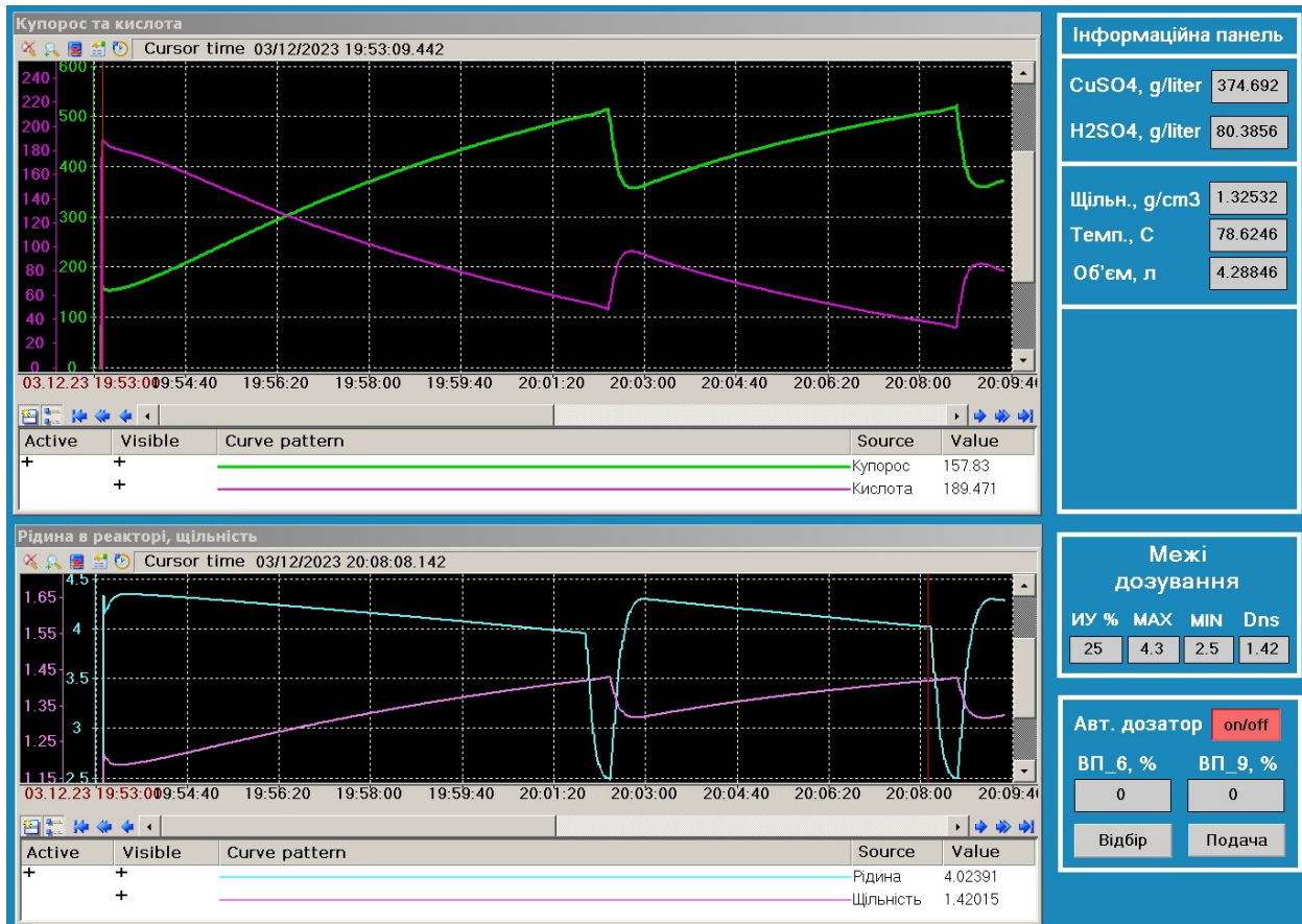
Рис. 8. НМІ системи керування, загальний вигляд
